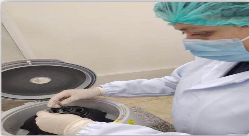
Fotografía 5: Centrifugamos el tubo capilar.
